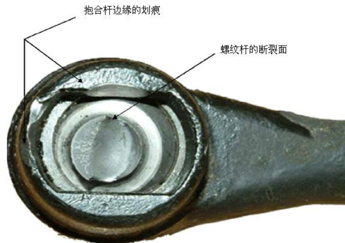
图4 螺纹杆的断裂面和抱合杆边缘的划痕
