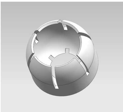
图 4-6 球头销座简化模型
