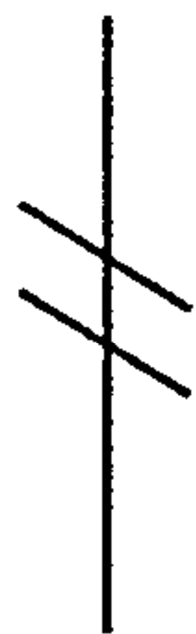
图 9 垂直管段的法兰连接画法(一)
