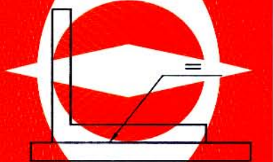
图8 粘接接合处的表示法(一)
