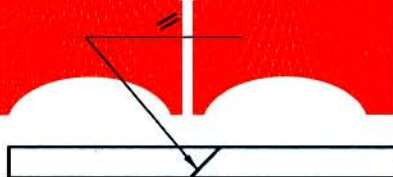
图9 粘接接合处的表示法(二)
