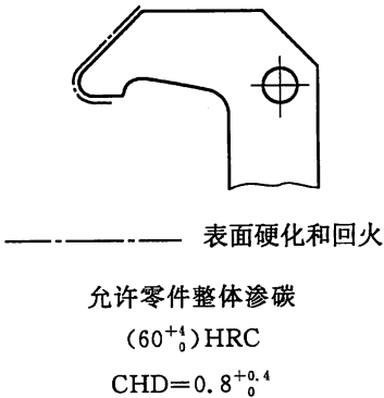
图 29 表面硬化的表示(七)
